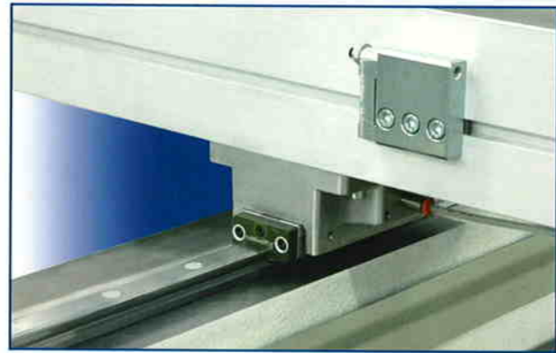
Scorrieri con guide lineari di alta qualità e precisione. Déplacement sur guides linéaires de haute précision. Gleitung auf hochqualitativen Präzisions-Linearführungen.
