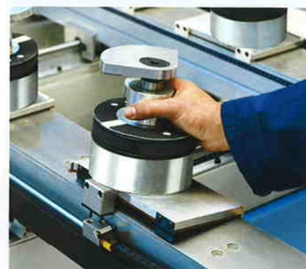
Scorrieri con guide lineari di alta qualità e precisione. Déplacement sur guides linéaires de haute précision. Gleitung auf hochqualitativen Präzisions-Linearführungen.
