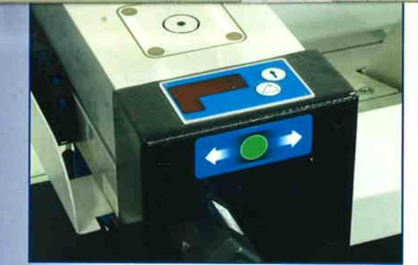
Display digitale per la visualizzazione dei dati, inviati dal CN, per la configurazione del piano macchina in base al programma di lavoro da eseguire.
