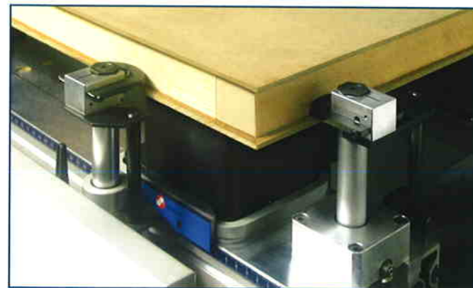
Battute per pannelli con bordi sporgenti (opt). Butées pour panneaux avec dépassement du chant (opt). Furnieranschlag für Werkstücke mit Furnierüberständen (opt).
