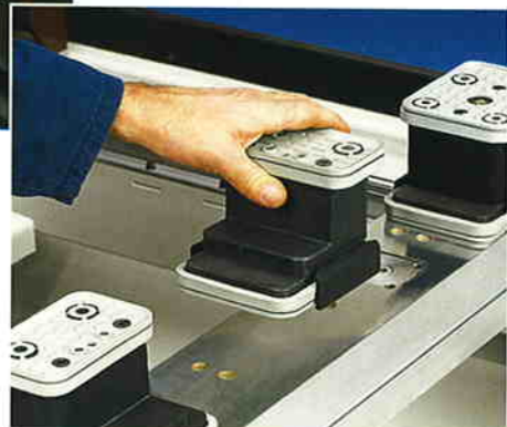
Scorrieri con guide lineari di alta qualità e precisione. Déplacement sur guides linéaires de haute précision. Gleitung auf hochqualitativen Präzisions-Linearführungen.
