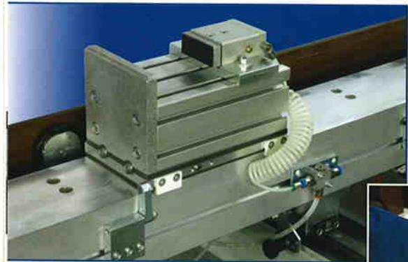
Il sistema di depressione permette il posizionamento rapido dei sistemi di bloccaggio riducendo notevolmente i tempi per la configurazione del piano di lavoro.
