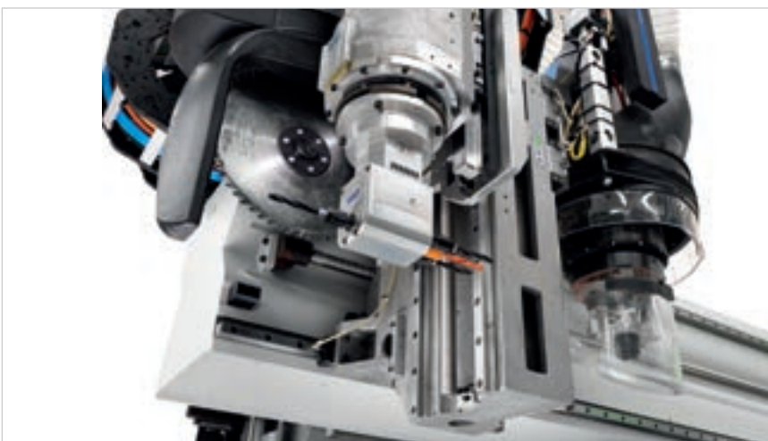
Électrobroche de 19,2 kW. Groupe lame D300. Groupe 3+1.
