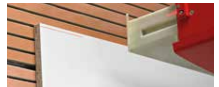
Affichage de la coupe horizontale, assisté par laser (de série).
