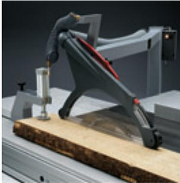
■ **Presseur pneumatique** : assure une parfaite fixation de la pièce sur le chariot à doubles rouleaux. Radiocommandable sans fil, le presseur exerce une force de serrage de 1 000 N max. La pièce est immobilisée sur le guide transversal. Pour le serrage de pièces de 90 mm max. ou de 80–170 mm d'épaisseur. Disponible avec un ou deux dispositifs de serrage.
