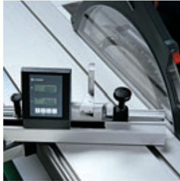
■ **Guide d'onglet transversal DIGIT LD** : ce guide est identique au DIGIT L, à ceci près que cette option offre également un affichage digital de l'angle. Un réglage d'une précision de +/- 1/100° est donc possible. La mesure de la longueur est automatiquement calculée en rapport avec l'angle d'onglet. La coupe d'échantillons n'est pas nécessaire.
