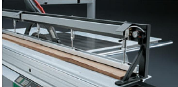
■ **Poutre de pression pneumatique** : en deux parties et réglable à distance séparément. Pour le serrage de pièces de 80 mm d'épaisseur max. Particulièrement pratique pour les matériaux longs et fins comme les placages.
