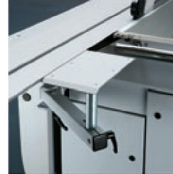
■ **Table avant** : surface d'appui supplémentaire pour pièces longues et étroites. Se place devant la table de la machine et est repliable.
