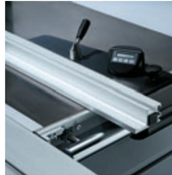
■ **DIGIT X :** affichage digital de la largeur de coupe du guide parallèle avec réglage fin manuel. Ce système de mesure électronique garantit le réglage précis et rapide du guide parallèle. Les valeurs de coupes fréquentes sont reproductibles avec exactitude et visibles sur l'écran DIGIT X. Le système fonctionne sans usure et est insensible à la poussière. La correction des mesures s'effectue automatiquement en cas de positionnement vertical ou horizontal du rail de butée.
