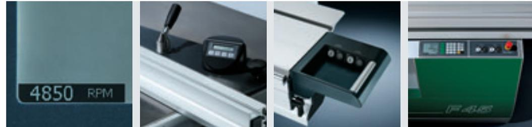
*Ce modèle est équipé de l'entraînement VARIO, de l'affichage digital de la largeur de coupe DIGIT X au guide parallèle et de l'interrupteur Marche/Arrêt sur le chariot à doubles rouleaux.*
