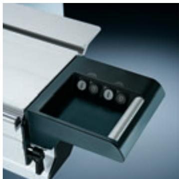
■ **Interrupteur Marche/Arrêt sur le chariot à doubles rouleaux :** une option pratique. L'interrupteur Marche/Arrêt sur le chariot à doubles rouleaux est toujours à portée de main. Les quatre touches permettent de mettre en marche et d'arrêter la lame de scie principale et l'inciseur. Cela réduit les déplacements superflus et accroît la sécurité. Vous pouvez ainsi aisément passer du panneau de commande de la machine à l'interrupteur du chariot à doubles rouleaux.
