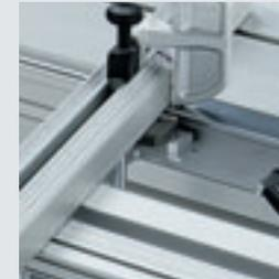
Lorsque vous découpez des onglets, la butée peut être réglée progressivement et précisément grâce au système de compensation de longueur : immédiatement et sans changement d'outil ni gabarit de réglage supplémentaire pour la compensation de longueur. Il suffit de déplacer la règle de butée sur la mesure d'angle sélectionnée selon l'échelle pour régler la longueur souhaitée à la butée.
