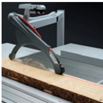
■ **Visualisation du trait de scie par rayon laser** : indique le trait de scie avec une longueur de rayon de 5 000 mm maximum, pratique pour le délignage et la coupe après une fissure, p. ex. pour les marches d'escalier. Gain de temps et de matériau assuré.
