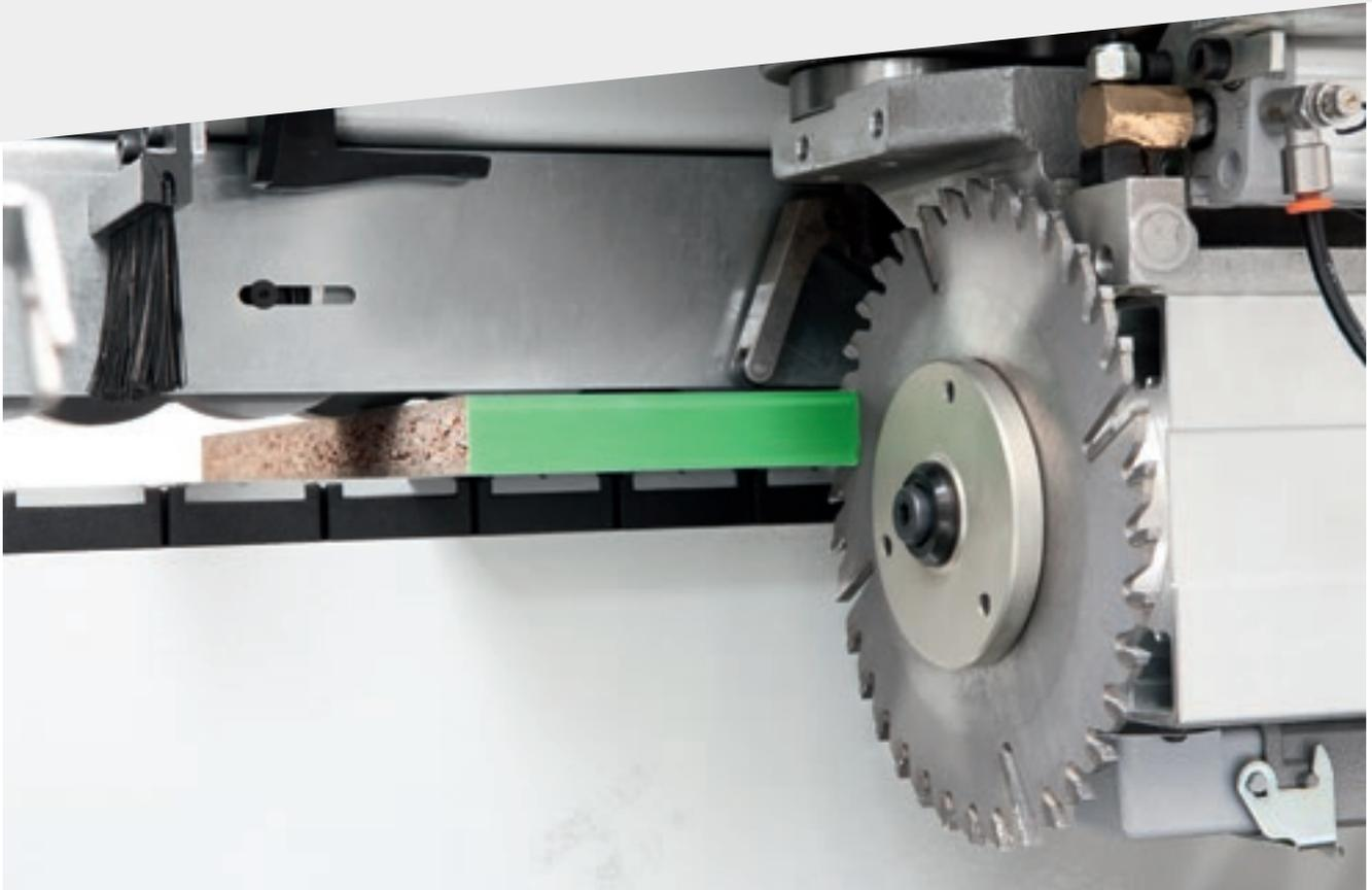
Fiabilité et précision de la coupe grâce au **Groupe de coupe** en bout pour éliminer la partie excédentaire du chant en tête et en queue du panneau. Le Groupe de coupe en bout prévoit de série le **Système Flex** qui permet de régler automatiquement la partie excédentaire du chant.
