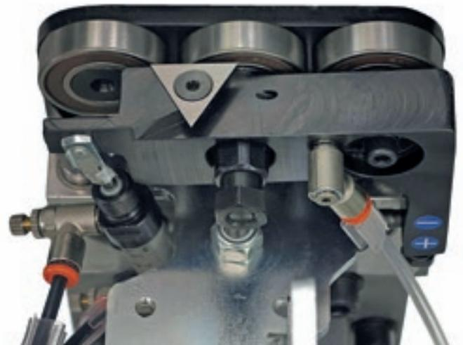
Le **Groupe racleur de colle** qui sert à éliminer les excès de colle dans la partie supérieure et inférieure du panneau, est le seul groupe présent sur le marché à être muni de 4 cylindres pneumatiques pour une haute qualité de finition.
