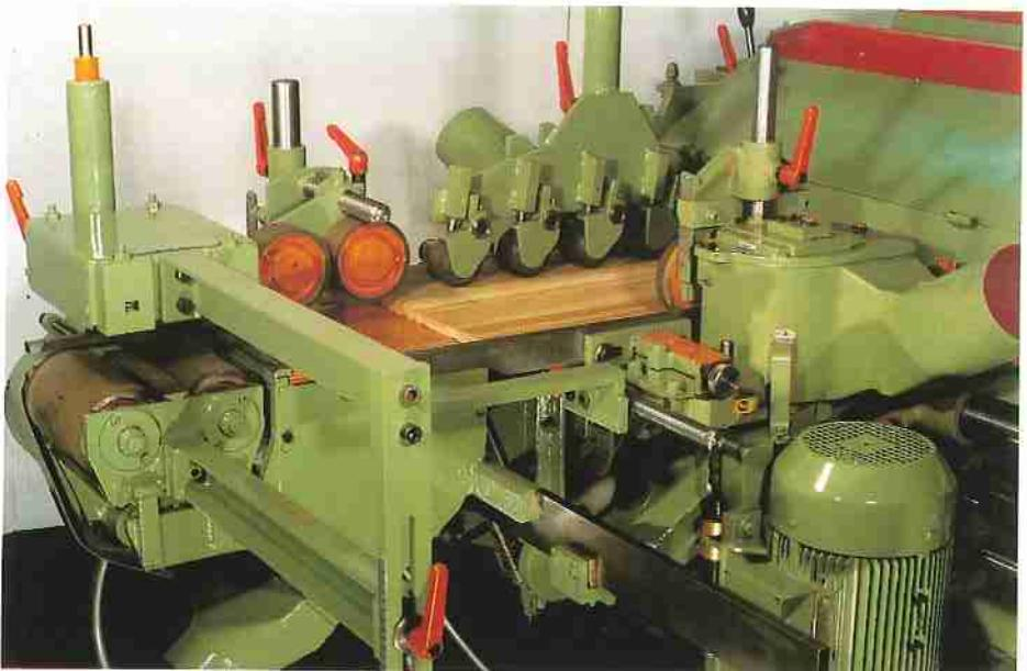
Vertikalbereich für die Kantenbearbeitung mit einer Zusatzhorizontaleinheit unten arbeitend.
