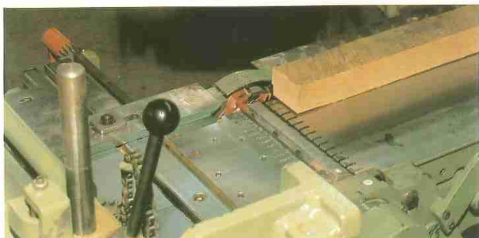
Messerkopf beglättet die untere Fläche, der Fügefräser fräst den Führungsfall in das Holz.
