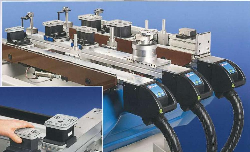
Il sistema di depressione permette il bloccaggio rapido delle ventouse riducendo notevolmente i tempi per la configurazione del piano di lavoro.
