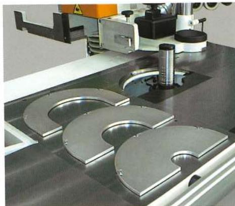
Dans le cas des usinages avec l'arbre, l'application d'un secteur derrière l'arbre assure un rendement élevé de l'aspiration.
