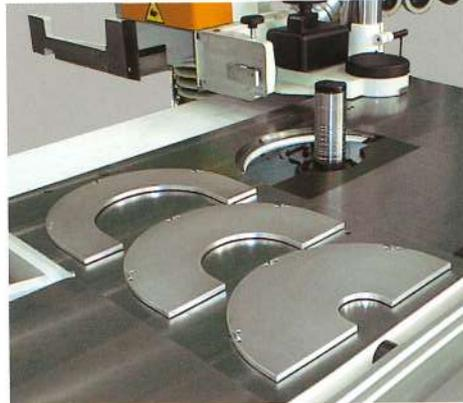
Dans le cas des usinages avec l'arbre, l'application d'un secteur derrière l'arbre assure le rendement élevé de l'aspiration.
