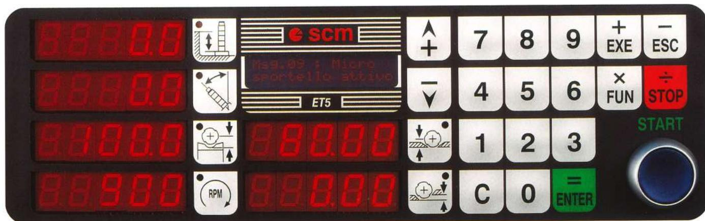
L'équipement en standard comprend le positionneur électronique de montée et inclinaison de l'arbre porte-outils et une boîte de dialogue d'aide pour les différentes fonctions à disposition.
