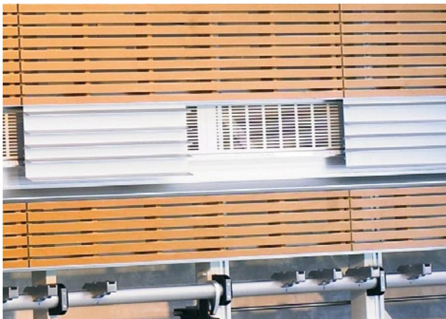
L'appui pour petites pièces en aluminium maintient les pièces travaillées bien fixes et sans flottement. L'appui pour petites pièces en bois est disponible en option. Il est ainsi possible de travailler sans problème de petites pièces à une hauteur de travail optimale.
