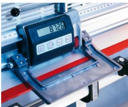
Le système de mesure numérique DMS présente une précision d'affichage de 1,0/0,5 et 0,1 mm. Il permet une commande rapide et très confortable, ce qui représente une économie de temps considérable. Il peut s'utiliser pour l'appui à rouleaux, l'appui intermédiaire et les coupes à liteaux.
