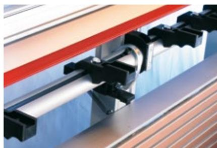
Les taquets high-tech en matière synthétique renforcée par fibres offrent une protection spéciale pour les matériaux d'arête et les arêtes postforming particulièrement sensibles.
