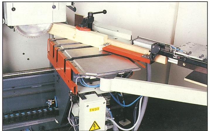
Schrägfenster: Manuelle Winkeleinstellung  $\pm 60^\circ$  Synchronisation Soll/Ist über Bildschirmanzeige. On-line-Fertigung mit automatischer Längenpositionierung des elektronischen Längenanschlages. Optimale Konterung durch Nachführleiste. Motorischer Tischvorschub, regelbar am Bedienpult.
