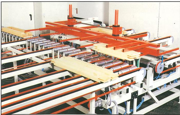
Ein Mann genügt! Die automatische Wendevorrichtung erspart das manuelle Wenden der Werkstücke am Zapfenschläger. Werkstücke mit linkem und rechtem Profil werden ohne Zeitverlust profiliert, ohne daß Sie dazu eine linke Spindel brauchen.
