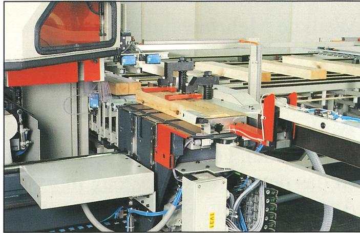
Elektronischer Längenanschlag. Auf dem Schlitztisch mitfahrend bis 3600 mm Holzlänge für Schrägensterfertigung oder feststehend bis 4500 mm. Die elektronisch gesteuerte Säge stellt sich automatisch auf unterschiedliche Zapfenlängen ein.
